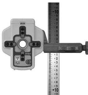
SF601 монтируется на рейке с помощью стандартного зажима приемника
