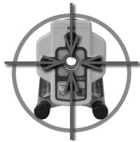
При применении режима **SpotLok** (аналогично PlaneLok) отвесный луч автоматически направляется в середину SF601 и удерживается там до отмены функции (обе оси Z+X).
