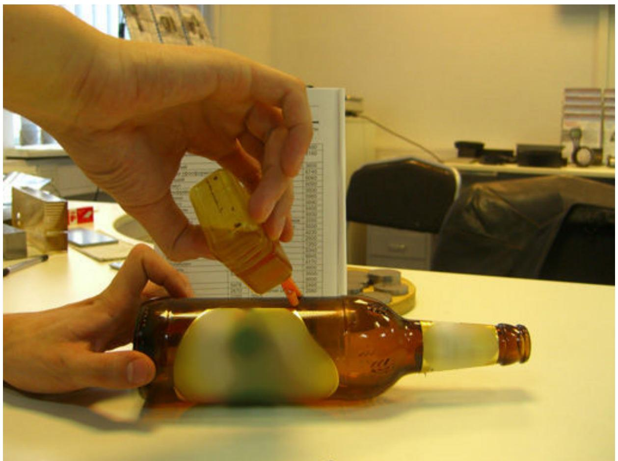
**Далее включаем прибор и устанавливаем преобразователь на поверхность бутылки. Первые измерения проводились сбоку на корпусе бутылки.**
