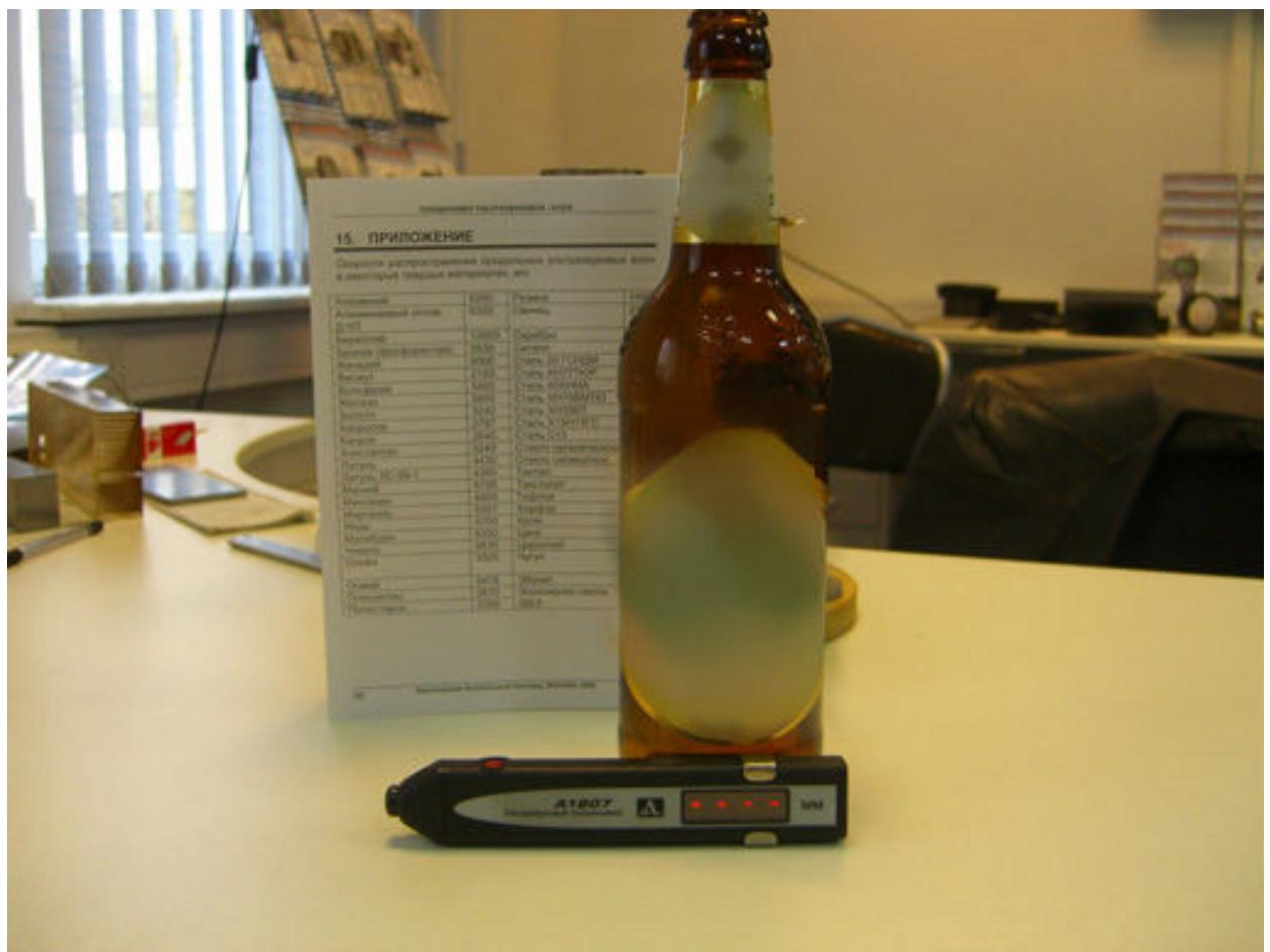
**Для проведения контроля в приборе надо выставить скорость распространения ультразвука в материале. В данном случае это силикатное стекло, скорость была взята из таблицы. V=5500 м/с.**
