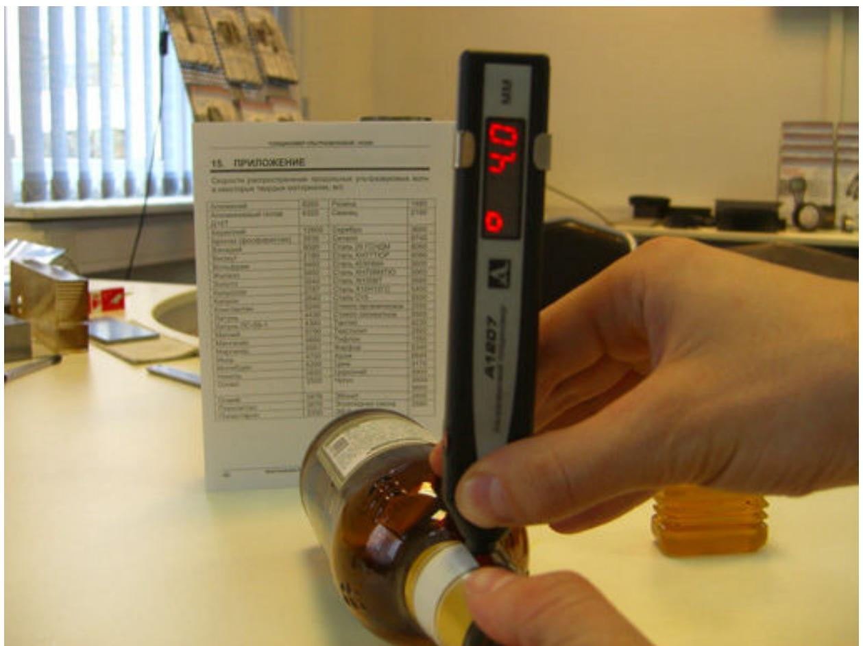
**Толщина на горле постоянна и равна 4 мм.**
