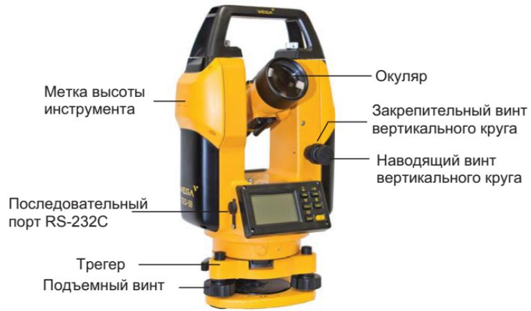
Рис. 3 Части прибора (круг Лево)
