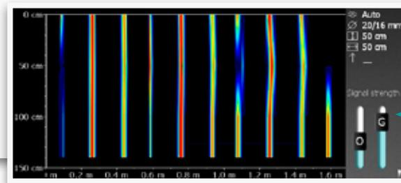
За счет перемещения ползунков "Компенсация" и "Усиление" можно настроить диапазон и разрешение мощности сигнала для его лучшего отображения в цветовом спектре, например, для выделения первого слоя арматуры
