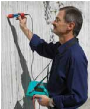
Стандартный медный / медно-купоросный стержневой электрод для локализованных измерений
