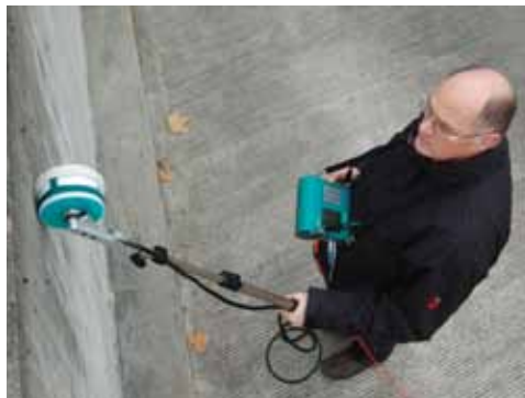
1-роликовый электрод для быстрого сканирования больших площадей
