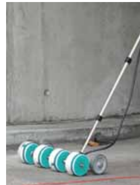
4-роликовый электрод для максимальной скорости измерения на больших площадях
