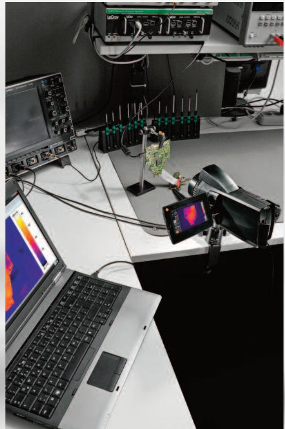
Любой фрагмент записи содержит данные температуры по каждому пикслю, что позволяет с точностью проанализировать все стадии процесса нагрева в течение определенного промежутка времени. Кроме того, функция регистрации данных обеспечивает возможность создания серии отдельных изображений в заданные временные интервалы или после определенных событий, например, превышения допустимых предельных значений.
