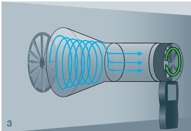
Выпрямитель потока testovent 417 позволяет изменить характеристики потока на вихревых диффузорах, что гарантирует максимальную точность результатов измерений.
