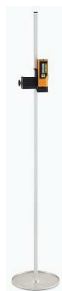
Рейка для установки лазерного приемника Ставится для установки приемника стационарно (контроль рабочей поверхности (пола) на одной высоте. Длина трубы-1,5 м. ø диска-38 см.
