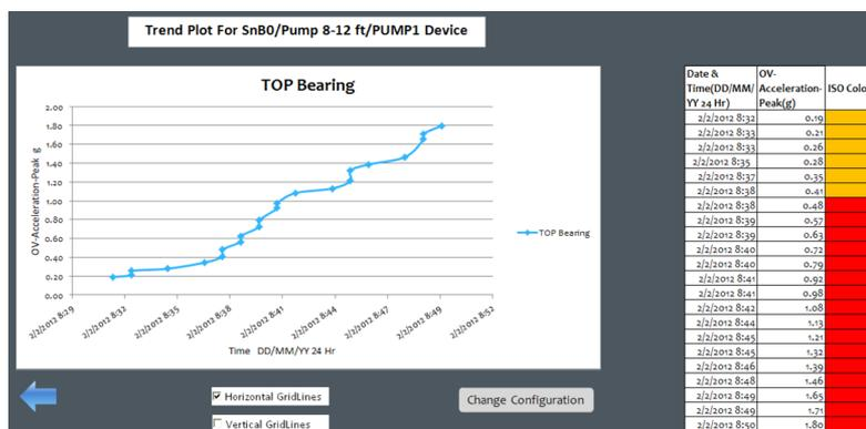
Пример графика, построенного с использованием шаблона Fluke 805.
