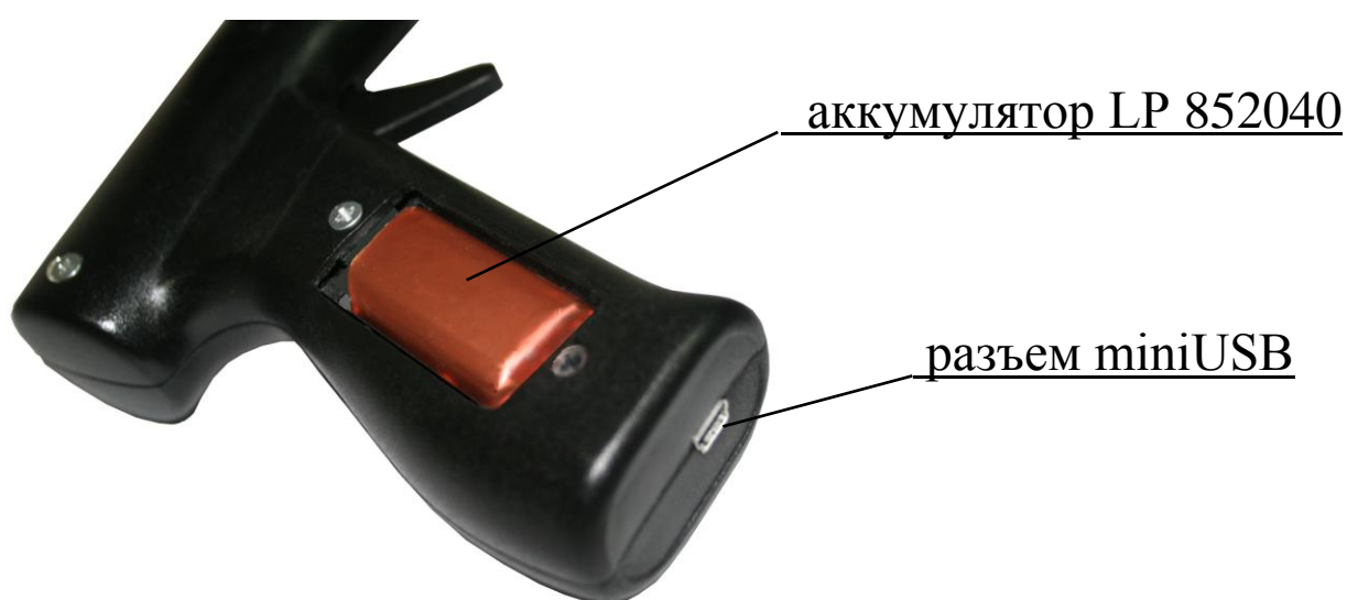
Рисунок 2 – Вид рукояти преобразователя прибора ИПС-МГ4.04
