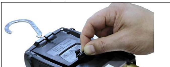
1. Откиньте кронштейн для подвешивания, ослабьте фиксатор и снимите крышку аккумуляторного отсека.
