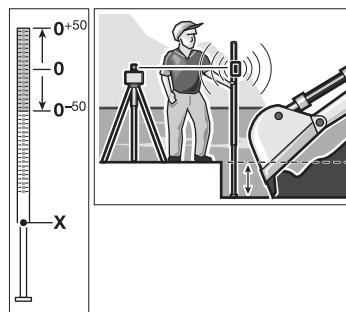
В верхней части дальномерной рейки **36** нанесена относительная измерительная шкала ( $\pm 50$  см). Нуль задается внизу на выдвижной части. Благодаря этому можно сразу видеть отклонения от заданной высоты.
