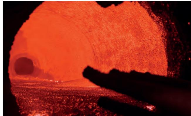
Производство клинкера (процесс обжига)
