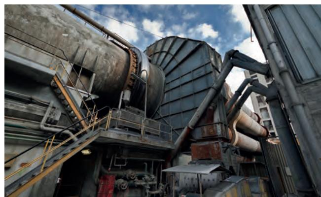
Обжиг гранулированного сырья в установке предварительного нагрева и роторной печи
