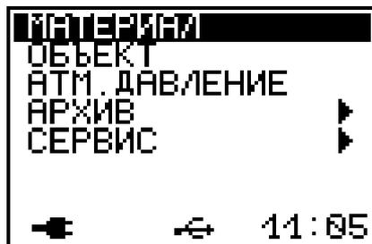
В нижней строке экрана, в зависимости от вида меню, высвечивается индикатор заряда батареи, текущее время, логотип USB-коннекта при подключении прибора к компьютеру. Кроме того, в некоторых подменю нижние строки индикатора могут содержать подсказки по активным функциональным клавишам.
